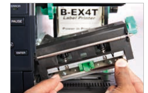
Minimum pracy przy wymianie głowicy, dociśnij i zatrzaśnij!
